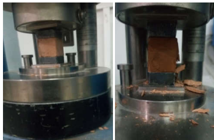
Figure IV-12 : Essais de compression sur les pâtes géopolymères
