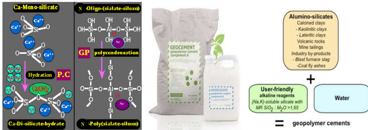
Figure I-3 : Réaction d’hydratation et de polycondensation du ciment Portland et du géopolymère respectivement [Chimie du ciment Portland vs chimie du ciment géopolymère].
