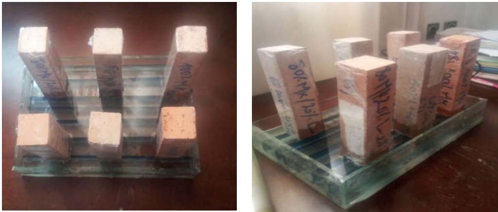
Figure IV-17 : Essai d'absorption capillaire.
