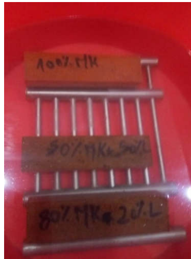
Figure IV-16 : Essai d'absorption d'eau par immersion totale.
