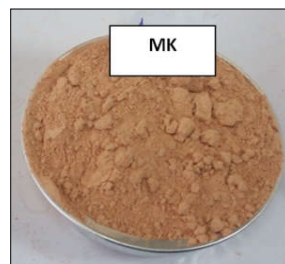
Figure IV-2 : Métakaolin MKT2 élaboré à partir de KT2.
