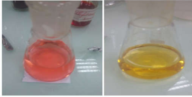
Figure III-12 : Essai de Frattini, titrage pour la détermination [\text{OH}^-]
