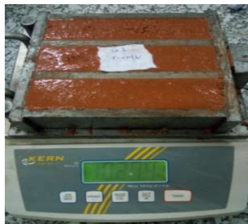
Figure IV-14 : Mesure de la masse volumique à l'état frais des mortiers géopolymères.
