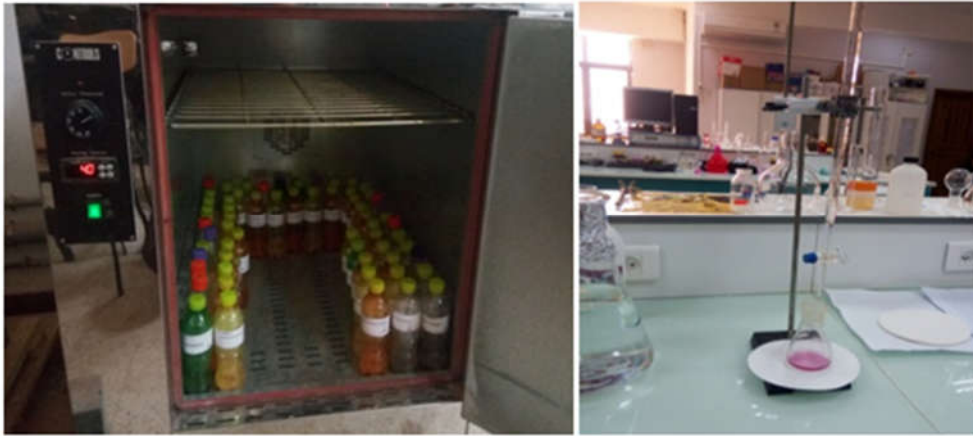
Figure III-11 : Essai de chaux saturée, conservation dans l'étuve et titrage à 1, 3, 7 et 28j.
