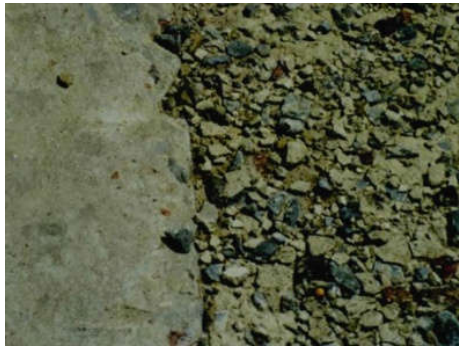
Figure I-15 : Comparaison entre les échantillons à base de béton Portland (à droite) et géopolymère (à gauche) [92].
