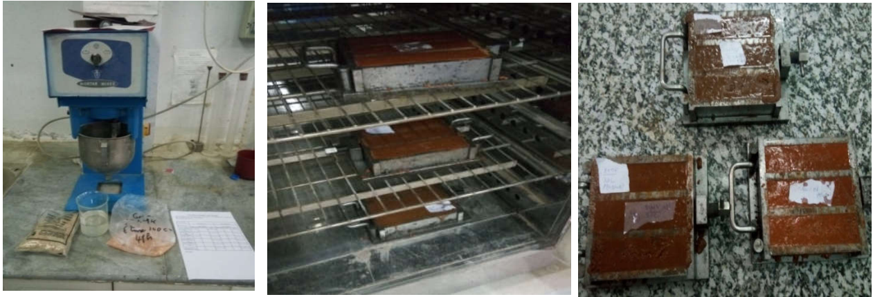
Figure IV-9 :Préparation et étuvage des mortiers géopolymères.
