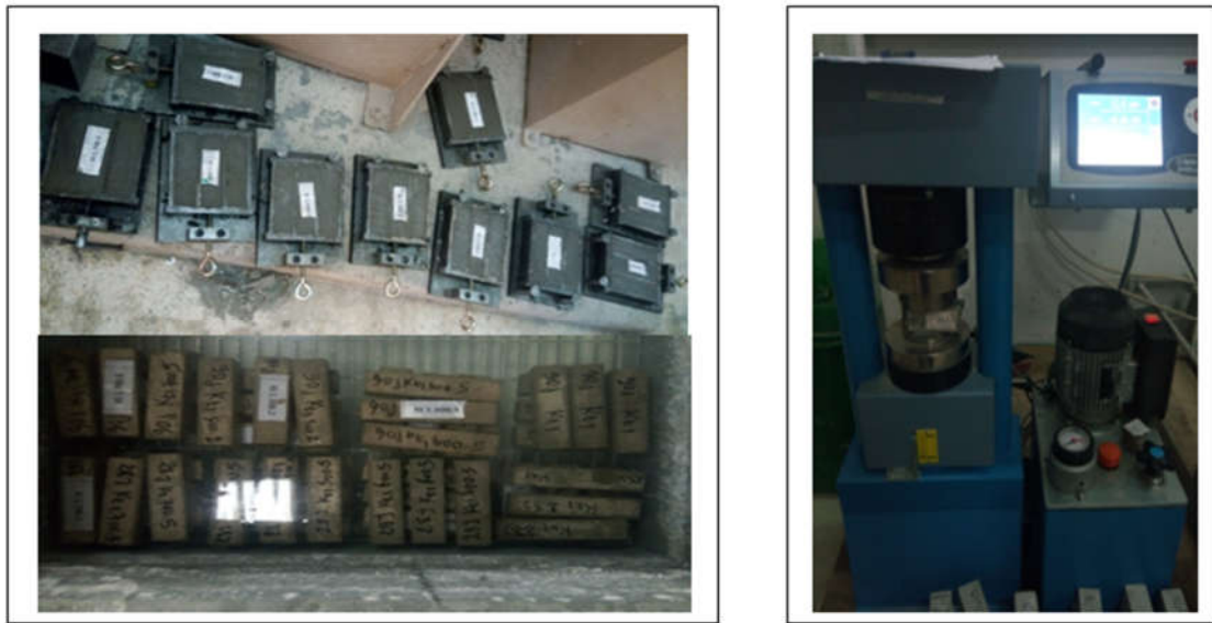
Figure III-10 : a) Confection et conservation des mortiers. b) Essais de résistance à la compression
