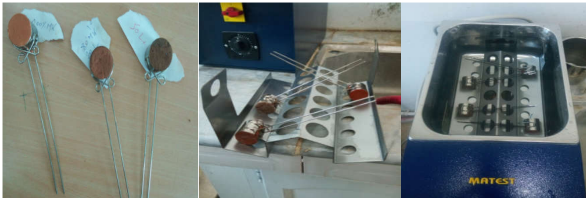
Figure IV-11 : Détermination de la stabilité par l'essai Le Chatelier ou essai d'expansion EN 196-3 [262].
