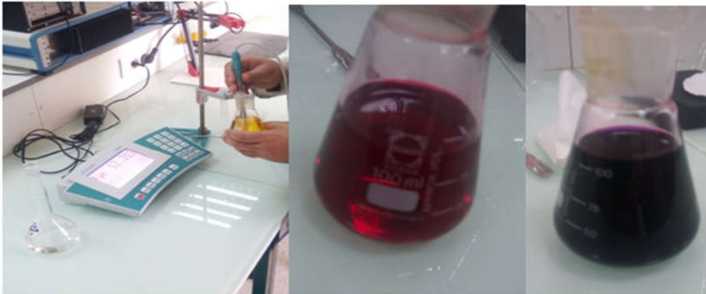
Figure III-13 : Essai de Frattini, ajustement de PH et titrage pour la détermination [CaO]
