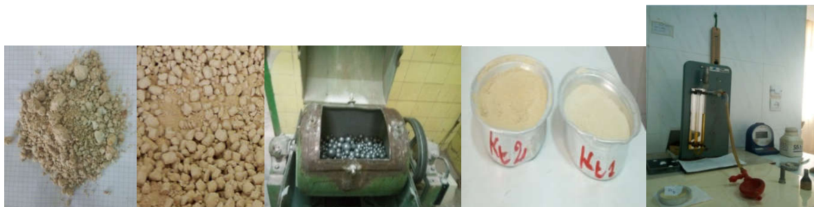
Figure III-7 : KT1 Brut -KT2 Brut -Broyeur à boulet -KT1 et KT2 Broyé -Appareil de Blaine
