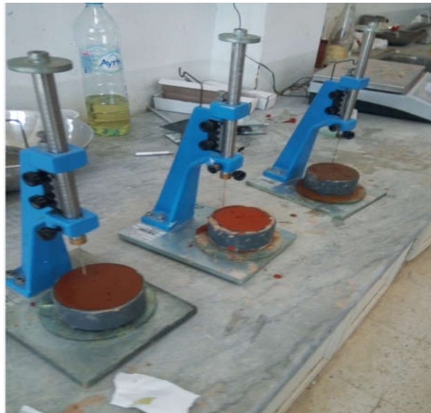
Figure IV-10 : Détermination du temps prise à l'aide de l'appareil Vicat.
