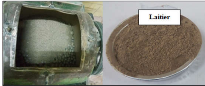
Figure IV-3 : Broyage de laitier L.
