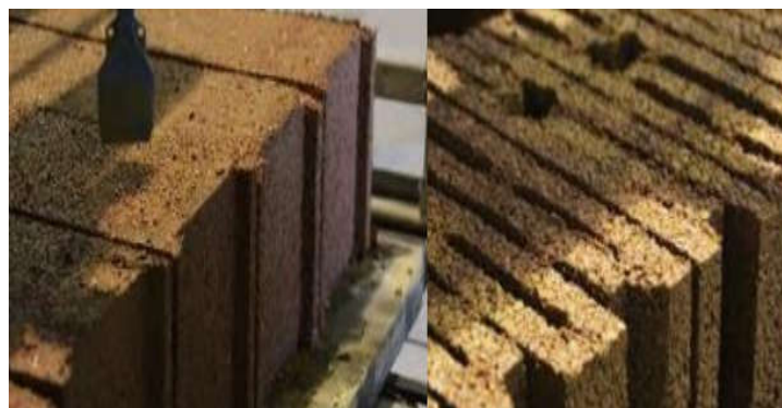
Figure I-14 : Parpaings fabriqués à base d'un béton géopolymère [91]
