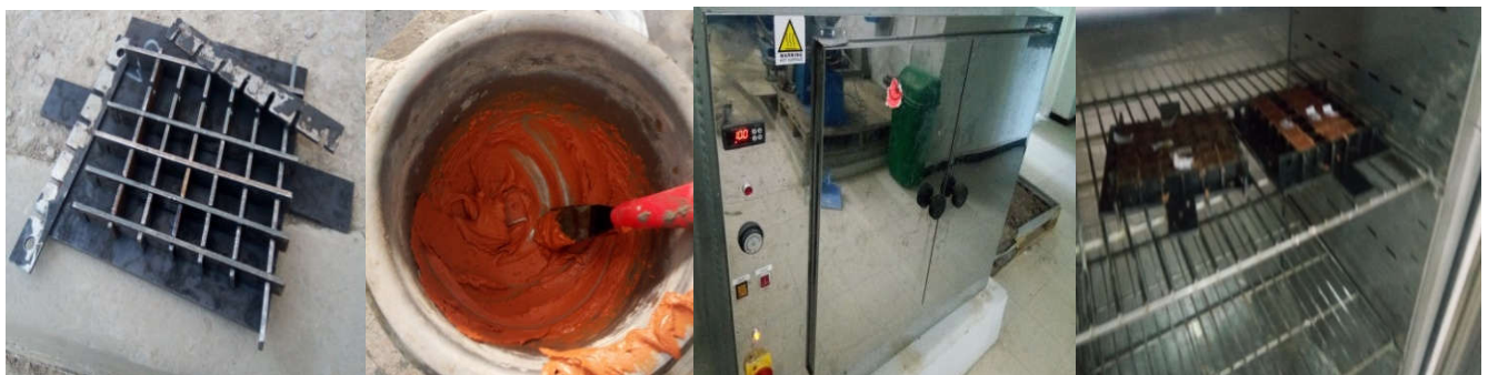
Figure IV-8 : Moule et étuve utilisés dans l'étude des pâtes géopolymères.
