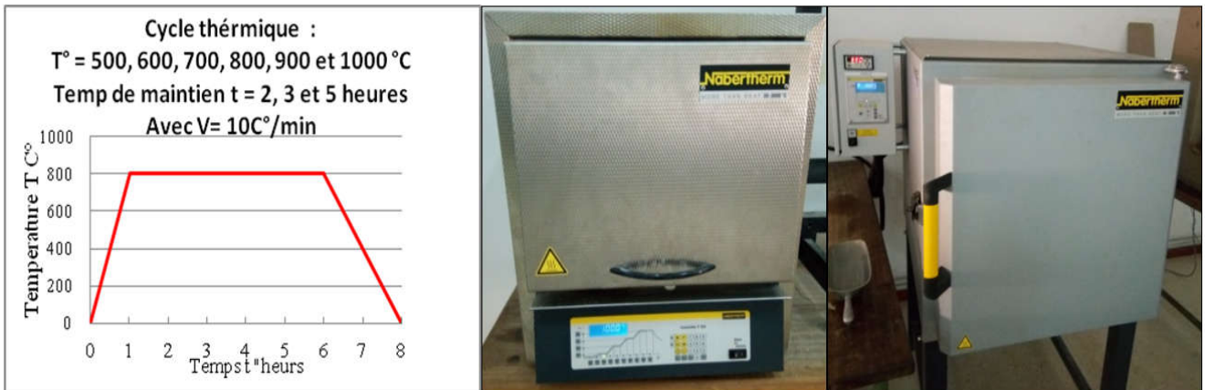
Figure III-9 : a) Cycle thermique b) 02 Fours Type Nabertherm pour calcination des kaolins
