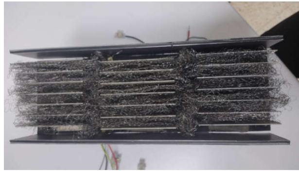
الشكل(III.15): يبين إضافة صوف الحديد بين شفرات المشنت.
