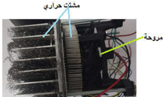
الشكل (4.III): يمثل مشتتات حرارية موضوعة على وجهي وحدة بلتيه مع استعمال مروحة
