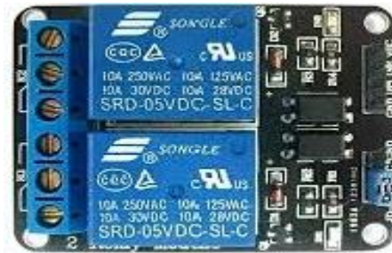
Figure (III.5) Relais utilisé (SRD-05VDC-SL-C)
