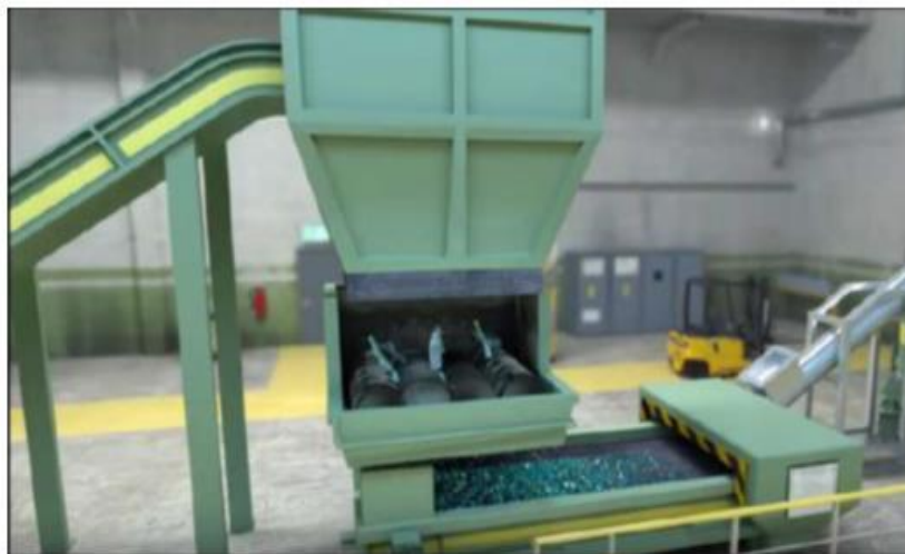
Figure II.14. Broyage des déchets plastiques
