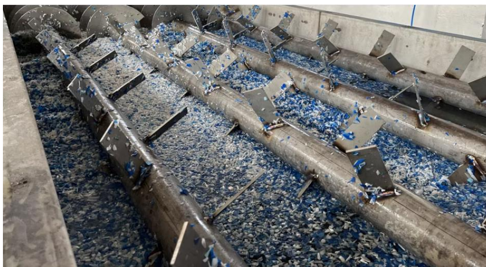
Figure II.15. Nettoyage des déchets plastiques
