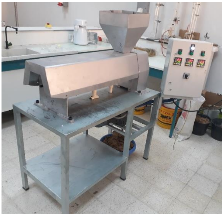
Figure IV.5. L'extrudeuse dans son état final
