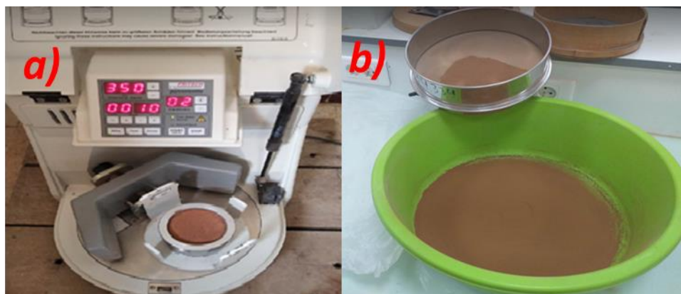
Figure IV.15. Préparation de chamotte a) Broyage ; b) Tamisage de la poudre chamotte
