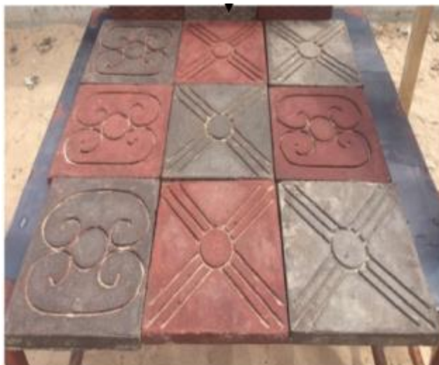
Figure III.7. Formation des tuiles à partir de sable lié plastiquement [29]
