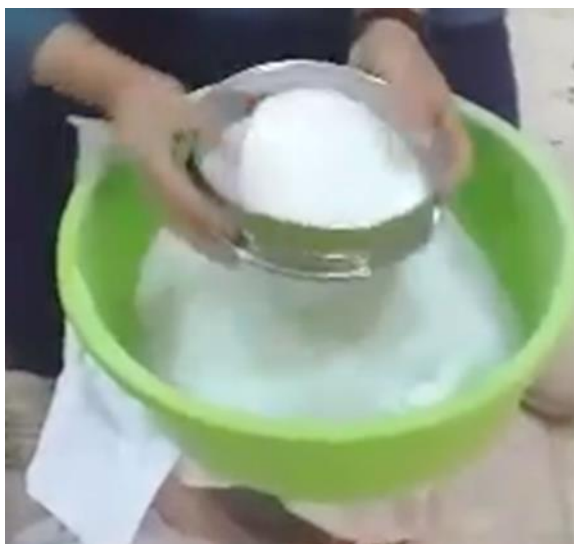
Figure IV.16. Tamisage de la poudre de marbre
