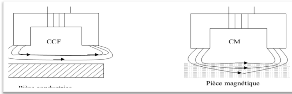
Figure 1. 8 Différente technologies des capteurs inductifs (CCF et CM) [4].
