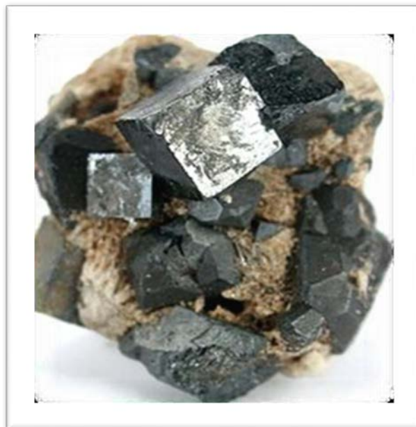
Figure (II.1) : La pérovskite Titanate de Calcium ( \text{CaTiO}_3 )
