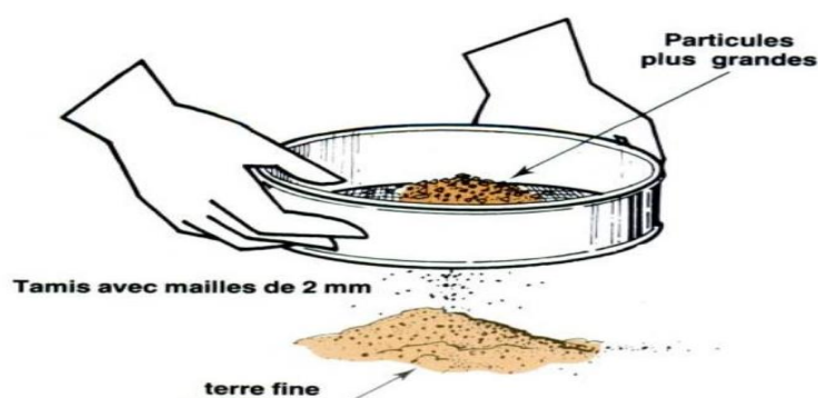
Figure III-4: Préparation de l'échantillon analyses (Tamisage) (FAO, 1986).
