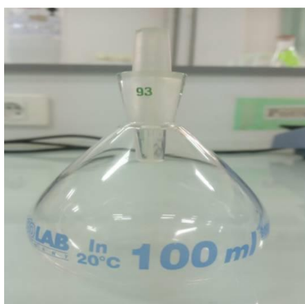
Figure III-5 : Pycnomètre utilisé pour la détermination de la densité réelle de nos échantillons (Photo original )
