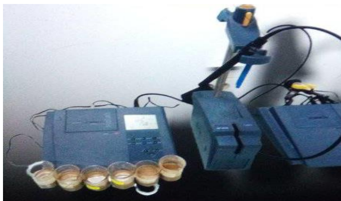
Figure III-8 : Conductivité-mètre utilisé pour la détermination du la CE de nos échantillons (photo originale)
