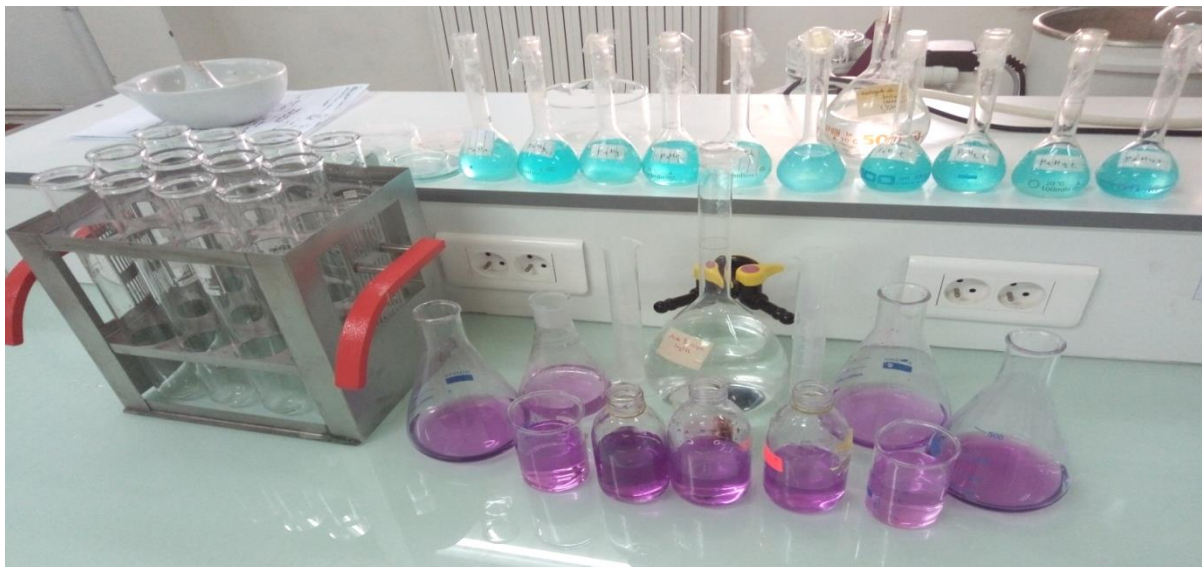
Figure III-17 : L'apparition de la couleur violette après titrage avec de l'acide sulfurique (photo original)
