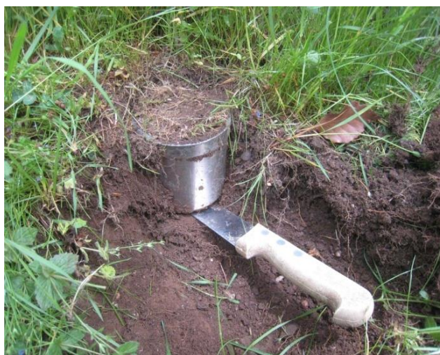
Figure III-6 : Cylindre enforcé dans le sol ( https://agripsol-prjet-agroforestrie .net )
