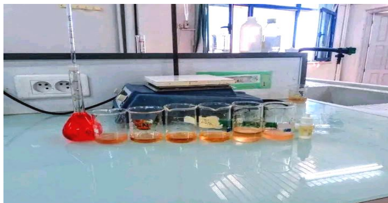
Figure III-12 : Titration de Carbonate et bicarbonate (photo original)
