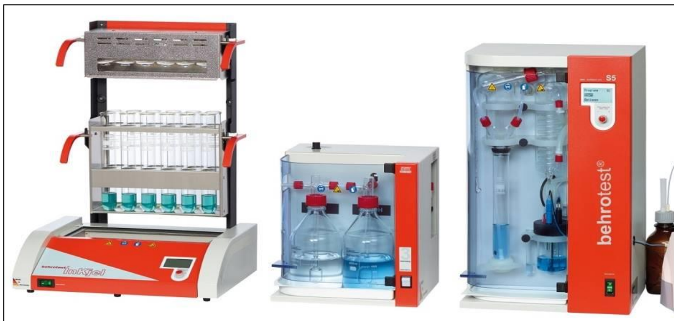
Figure III-18 : Appareil de Kjeldahl (مظفر احمد الموصلي. 2020.)
