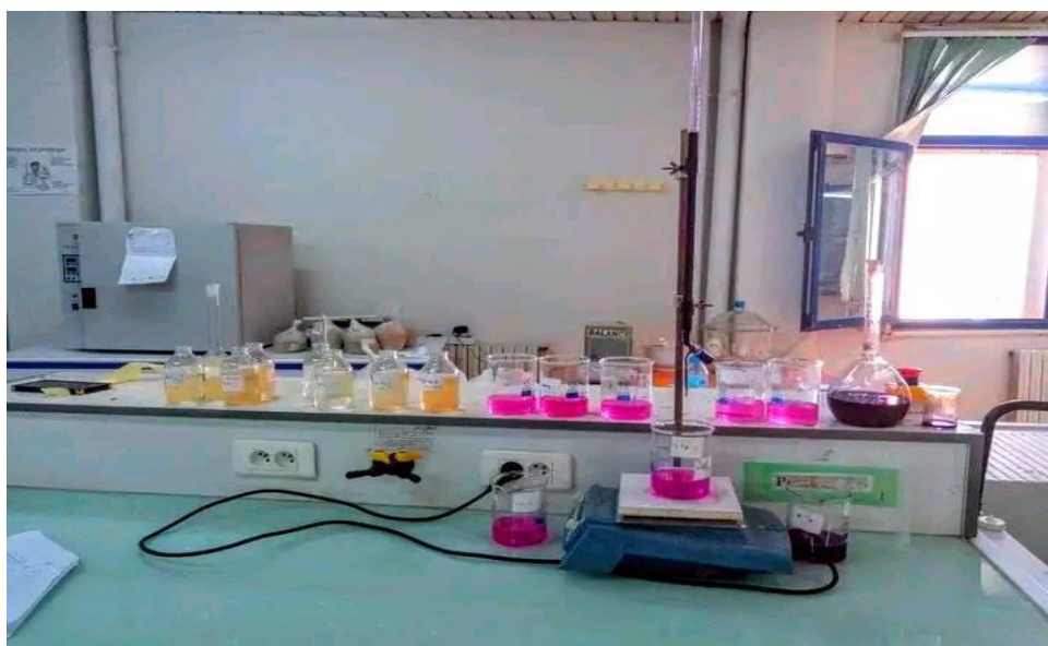
Figure III-10 : Titrations lors de mesure du calcaire actif des sols analysés (photo original)
