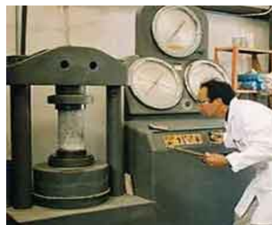
Fig. I.3 : Ecrasement d'éprouvettes de béton avec une presse hydraulique
