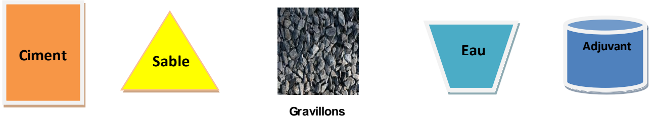
Fig. I.1 : Les composants du béton.
