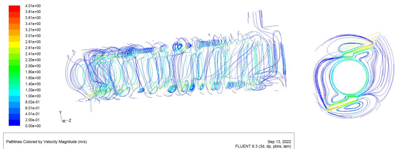
Figure I.10 Les lignes de courant dans l'échangeur à 02 lames pour une vitesse de rotation \Omega=600\text{tr/min} et un débit massique \dot{m}=0.035\text{kg/s} .
