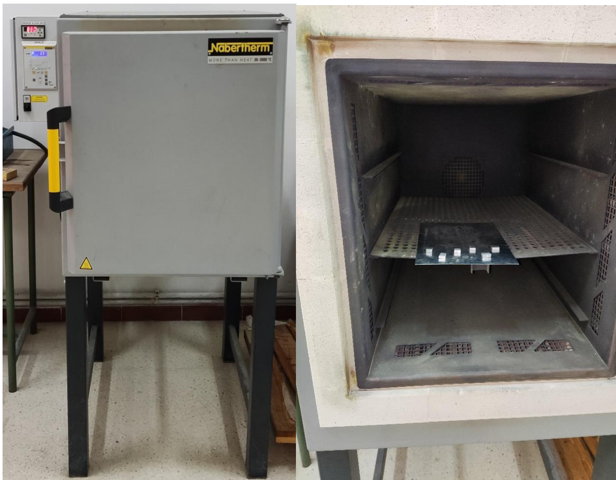
Figure II.5 : four de traitement thermique
