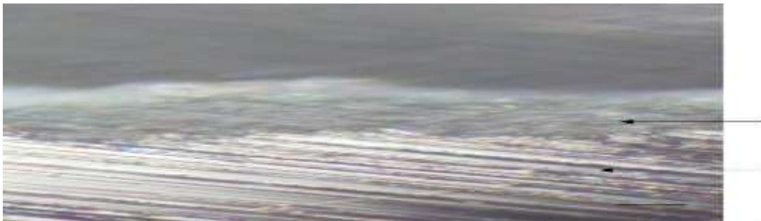
Figure IV.7: photo par microscope optique micrographique d'un revêtement d' Al_2O_3
