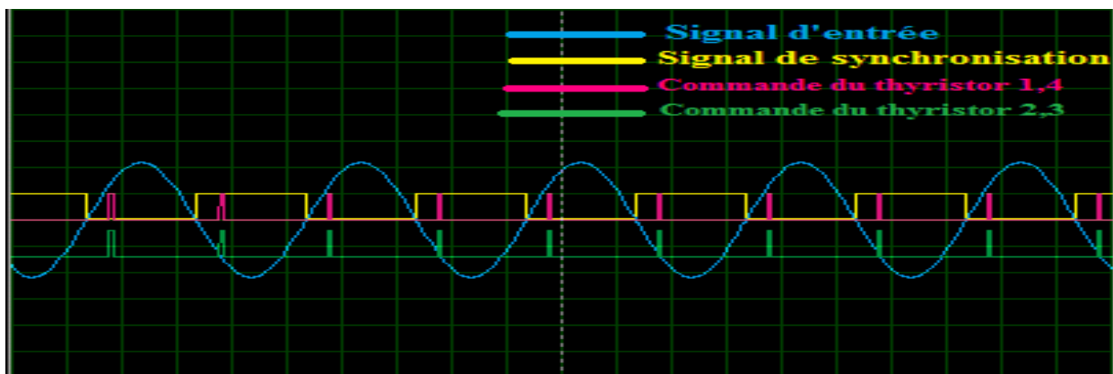
Figure II. 11 : Allures des signaux d’entrée, de synchronisation et de commande pour mode#0.
