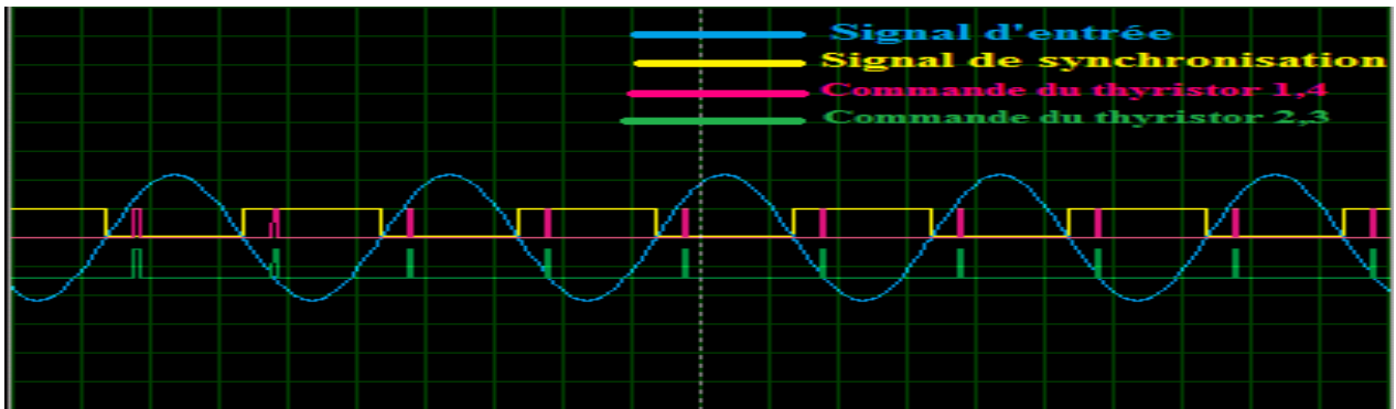
Figure II. 17 : Allures des signaux d'entée, de synchronisation et de commande pour le mode#1.
