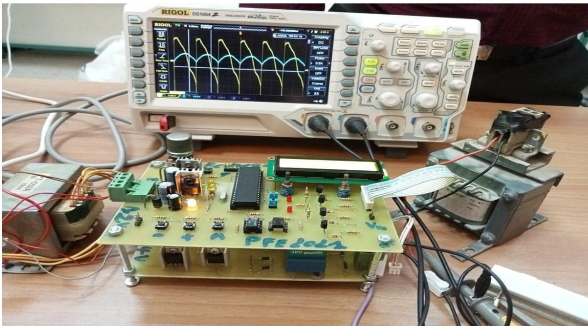
Figure III. 24 : allures de la tension et le courant de sortie
