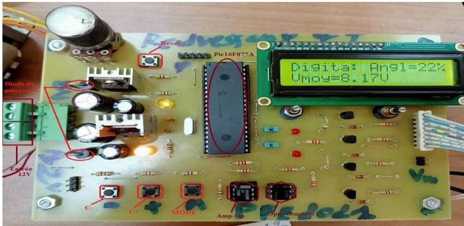
Figure III. 19 : Carte de commande finalisée (côté composants).
