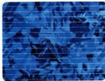
Fig. II.4. Cellule au silicium polycristallin [6].
