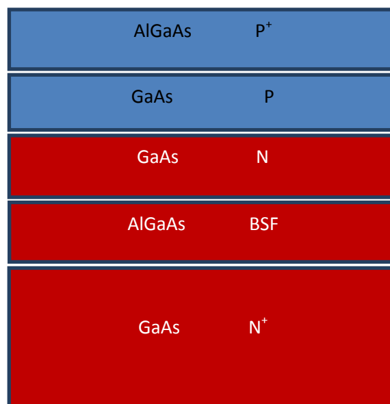
Fig. III.5. Schéma de la cellule solaire à base d’AlGaAs/GaAs/GaAs/BSF.
