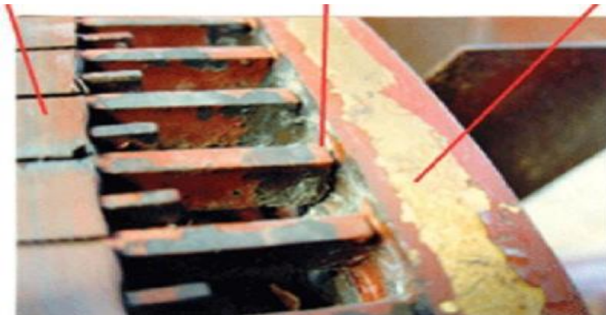
Figure1.12: Exemple d'un défaut de cassure de barre d'un moteur asynchrone
