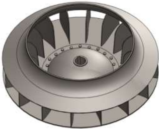
Figure III.10 : Assemblage des éléments de la roue
