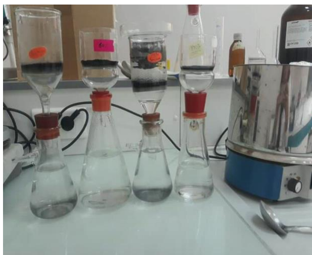
Figure IV-3- l'étape de lavage
