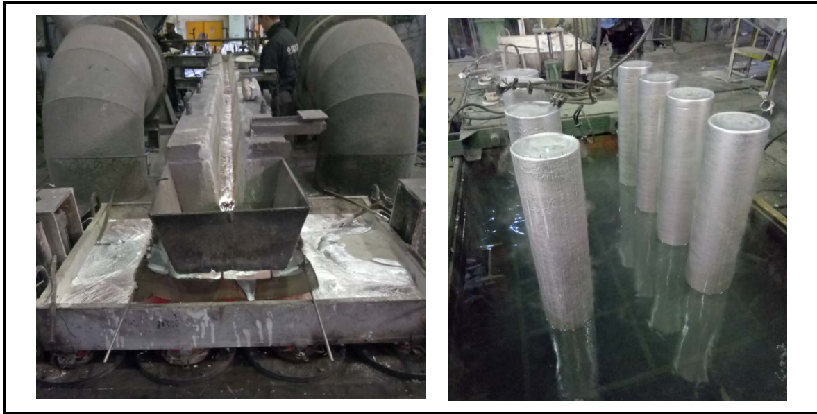
Figure 1.10 : Image réelle de l'opération de la coulée à ALGAL PLUS – Année 2020.
