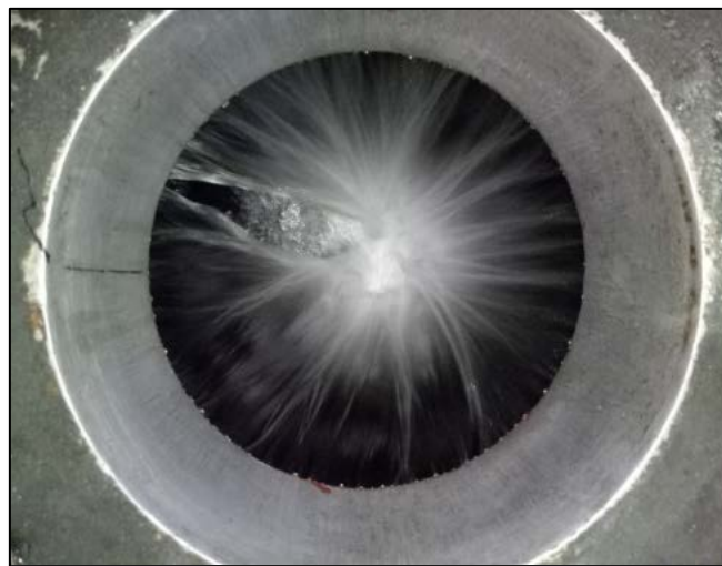
Figure 1.9: Forme circulaire de cascade d'eau de refroidissement.
