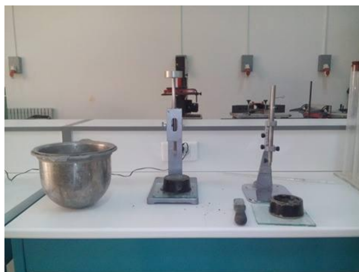
(Figure III.11) préparation la pâte de ciment aux niveaux de laboratoire
