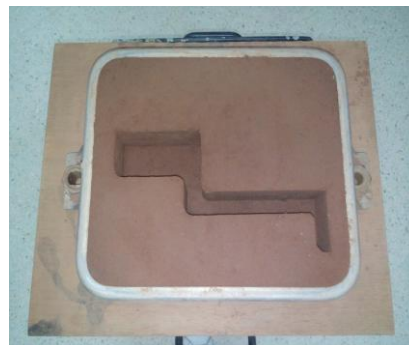
(Figure III.1) La forme de support dans le sable
