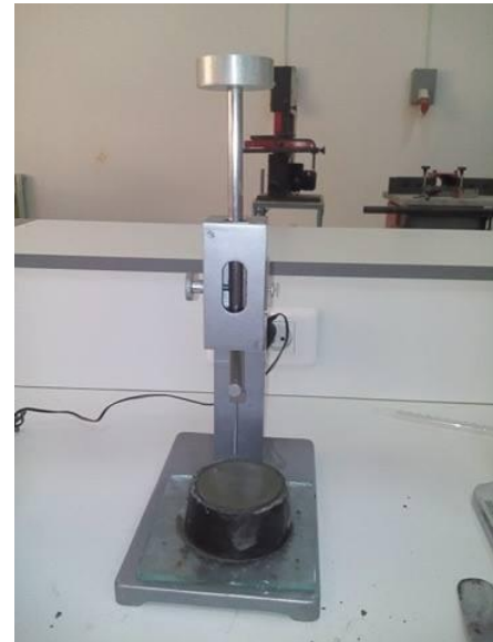
(Figure III.12) L'aiguille de Vicat s'arrête à une distance du fond du moule de d = 4\text{mm}
