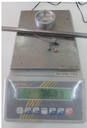
(Figure III.7) mesure le Poids de les éléments port poids + aiguille + vis de fixation + L'axe mobile
