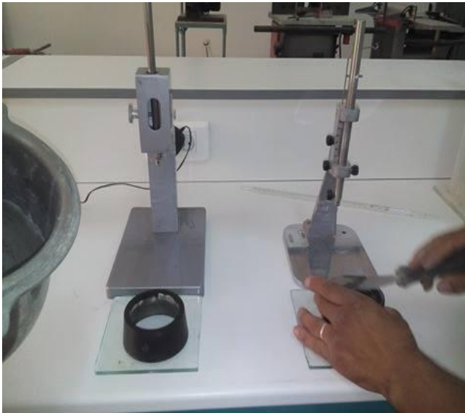
(Figure III.12) L'aiguille de Vicat s'arrête à une distance du fond du moule de d = 4\text{mm}
