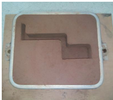
(Figure III.1) La forme de support dans le sable
