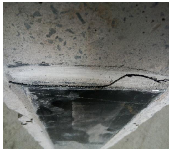
Figure (VI-5) : Mode de rupture par cisaillement des poutres renforcées par M1
