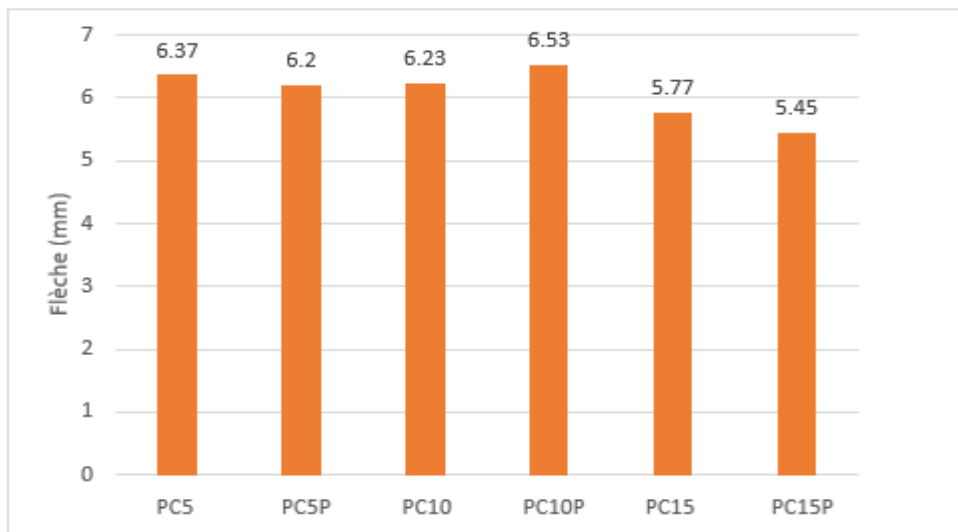
Figure (V-18) : Evolution de la flèche ultime en fonction de taux de corrosion pour les poutres corrodées et préfissurées/corrodées
