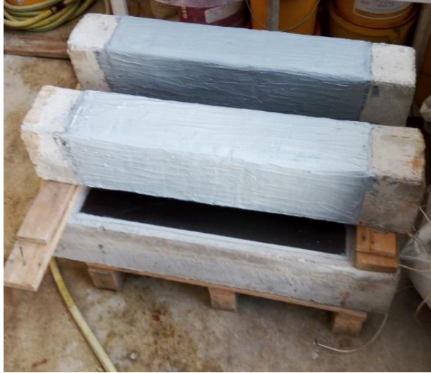
Figure (VI-3) : La réparation par la méthode mixte, lamelle + tissu en PRFC (M2)
