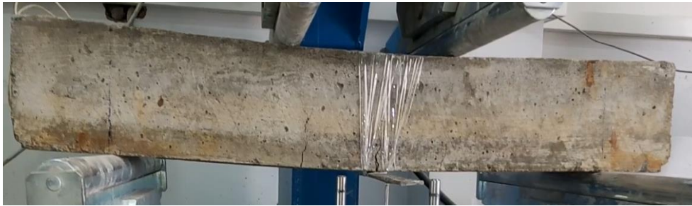
Figure (V-10) : Mode de rupture des poutres corrodées
