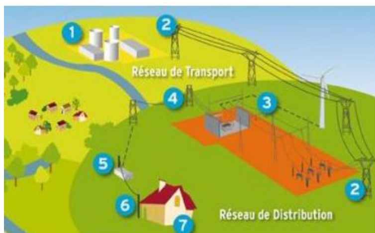
Figure 1.12 Réseau de distribution. [15]
