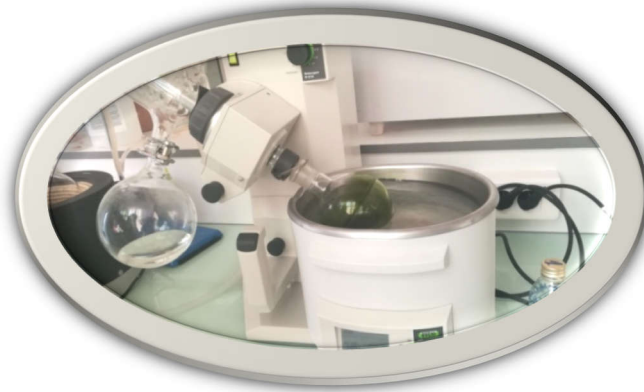
Figure 9 : Elimination de solvant par évaporation rotatif "BÜCHI" .
