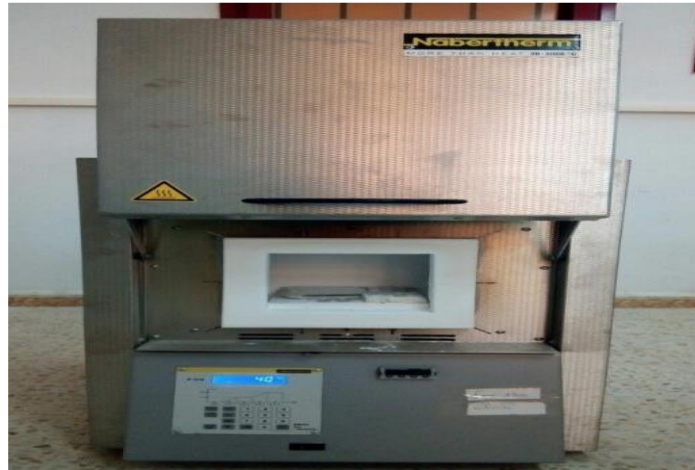
Figure II.6. Four électrique (T° Max : 1750°C).
