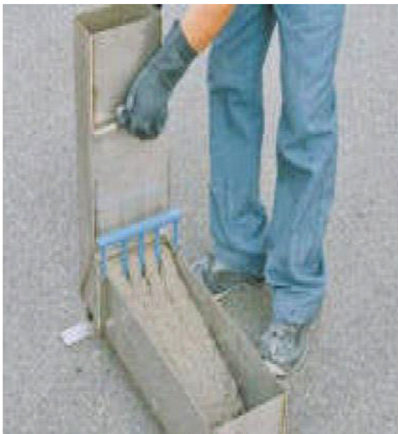
Fig 1.6. L'écoulement de BAP dans la boîte en «L»
