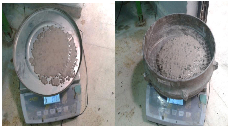
Fig 1.8. Dispositif de l'essai de stabilité au tamis
