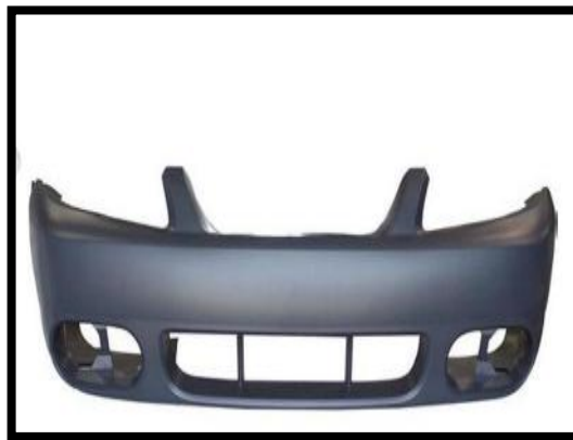
الصورة رقم 12: قطع غيار السيارات البلاستيكية من PP
