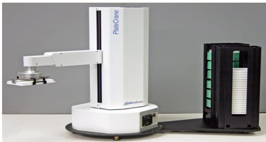
Figure I.9 : Un robot cylindrique.
