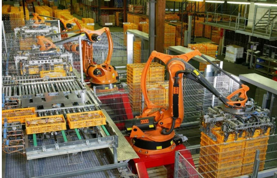
Figure I.7 : Des robots anthropomorphes au travail dans une usine.
