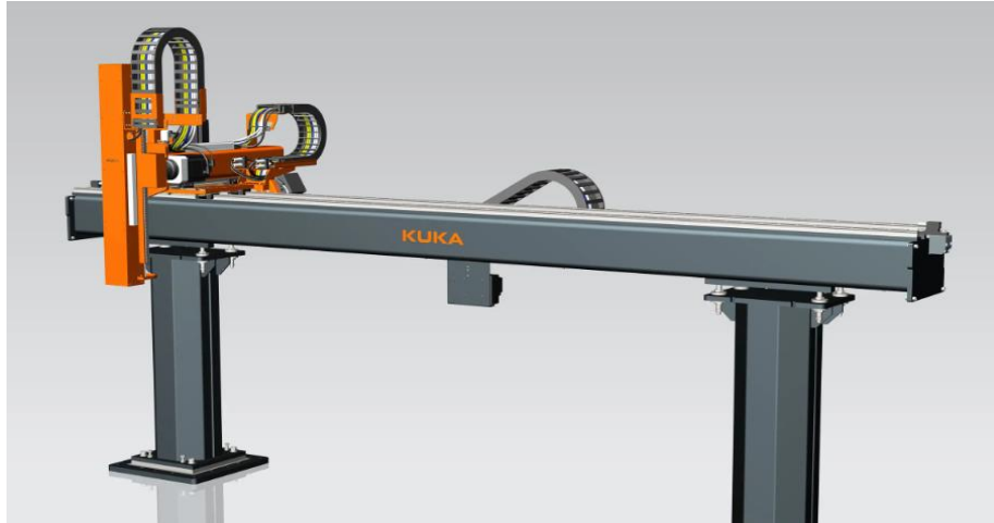
Figure I.8 : Robot cartésien PPP kuka.
