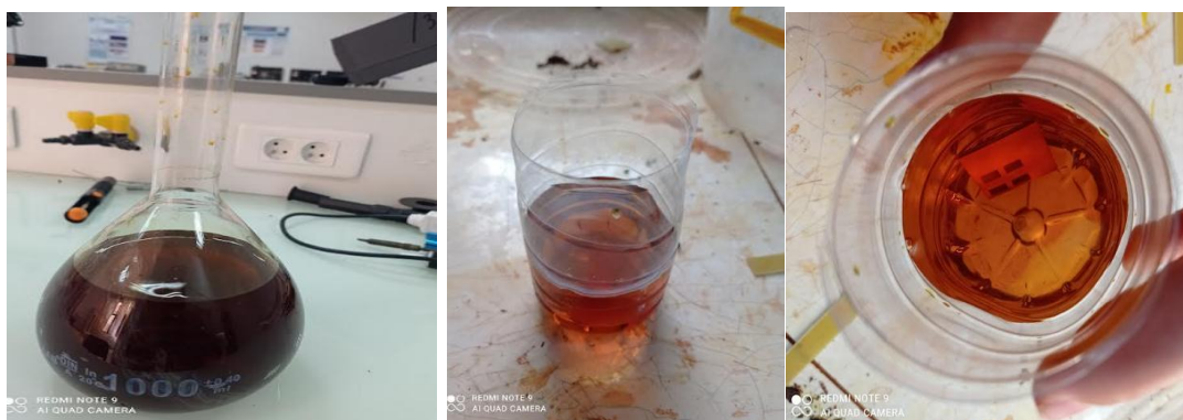
Fig.IV.29 : Etape de révélation à l'aide de perchlore de fer liquide.
