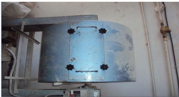
Figure I.4 Appareil de l'essai LOS ANGELE
