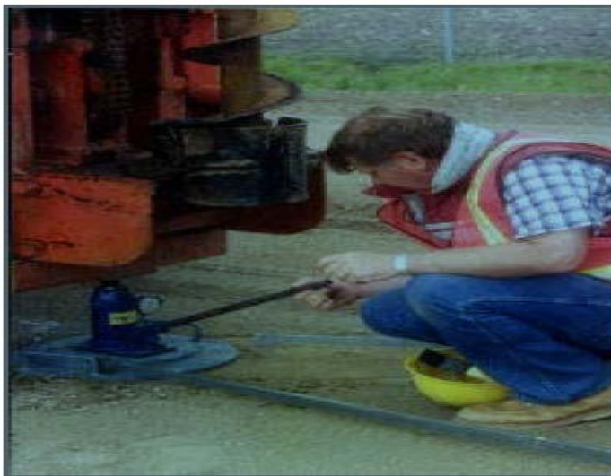
Figure III.5 Essai à la plaque Mehrez KHEMAKHEM Essais Géotechnique Routière)
