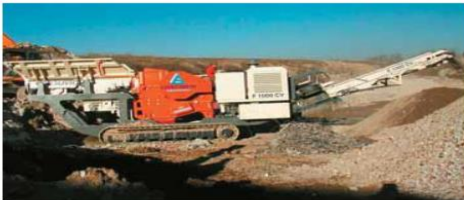
Figure II.11. Concasseur situé au niveau de la carrière [12].
