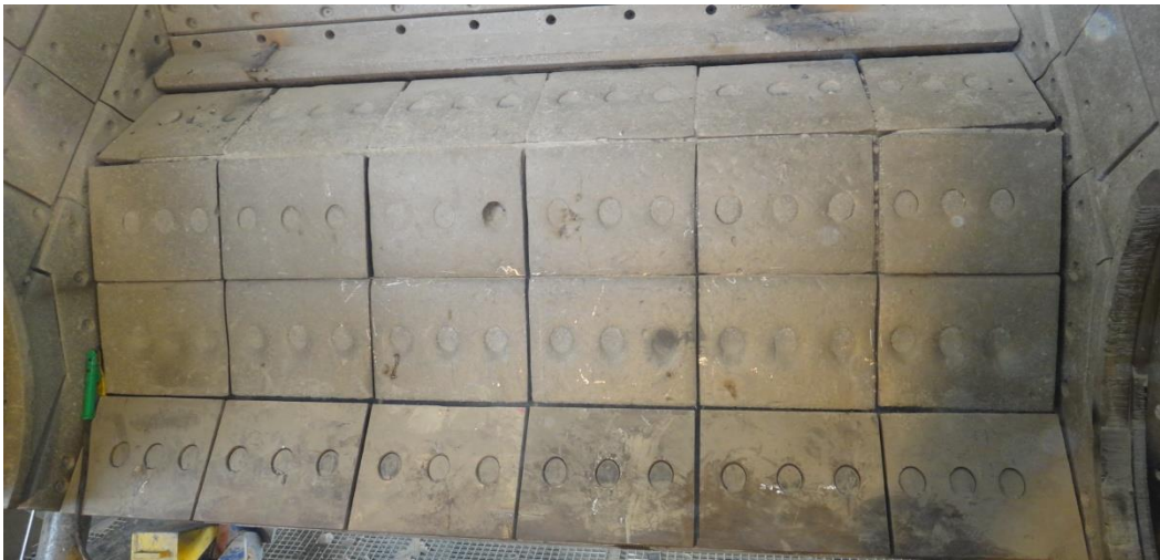
Fig. plaque de blindage d'enclume usée.
