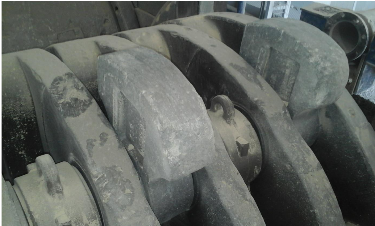
Fig. marteaux de concasseur usés d'un seul côté.
