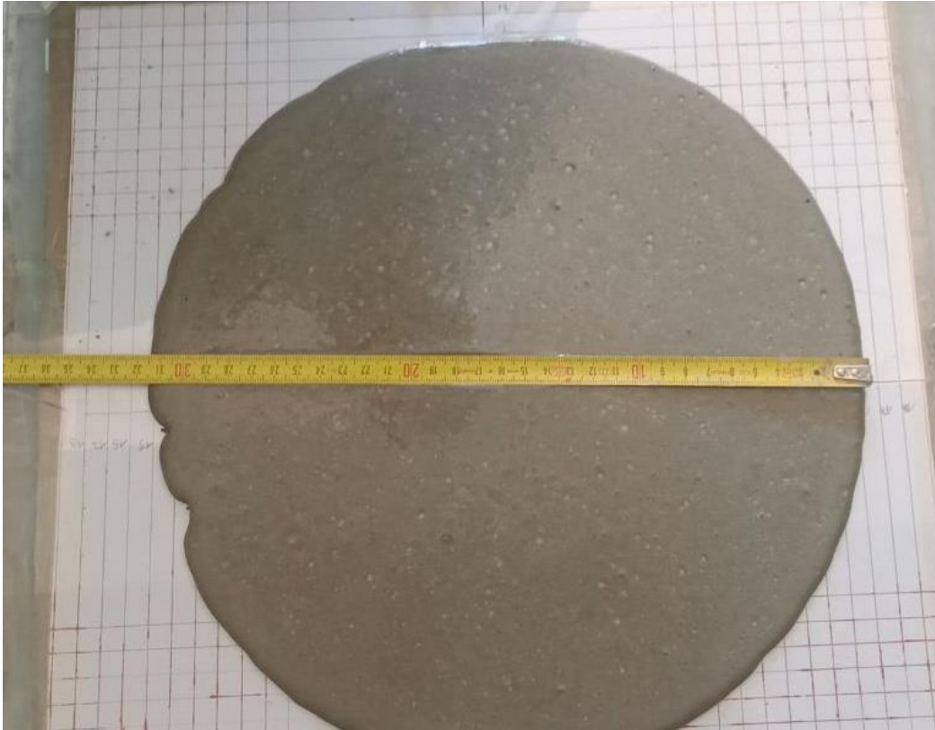
Figure II.13 : l'étalement au mini cône du mélange avec un rapport E /C = 0.35
