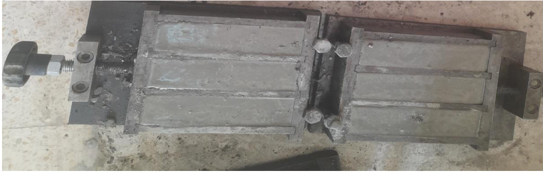
Figure II.24 : Moulage des spécimens cubiques de dimensions (4x4x16 cm 3 )
