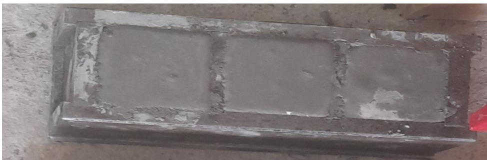
Figure II.23 : Moulage des spécimens cubiques de dimensions (5x5x5 cm 3 )
