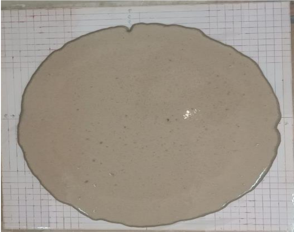
Figure II.9 : L'étalement au mini cône de mélange avec un rapport E /C = 0.45
