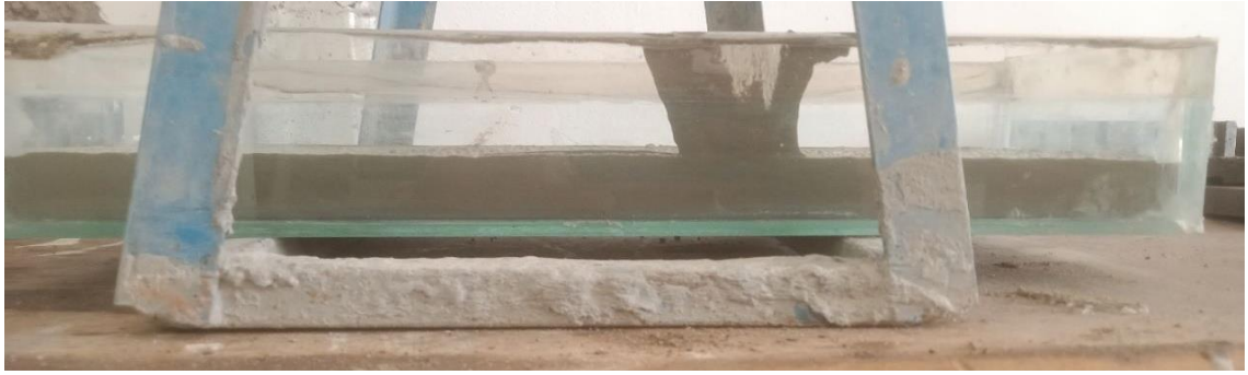
Figure II.17 : Effet de 05% de polystyrene sur l'autounivlement.
