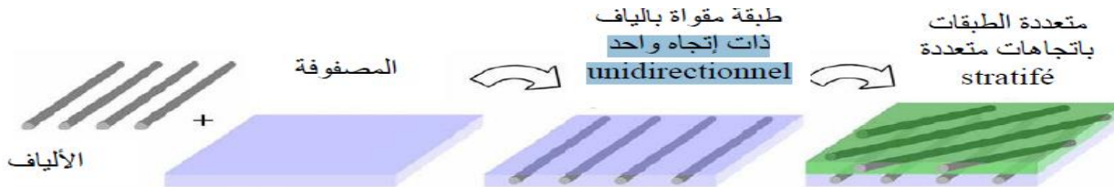
الشكل (5-1): تصنيف المواد المركبة حسب شكلها [8].
