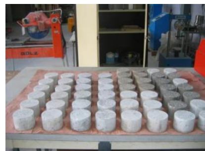
Figure 5.4 : Sciage des éprouvettes 16 x 32 cm de béton
