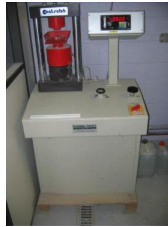
Figure 4-5 : Mesure de la résistance la compression sur demi-prismes
