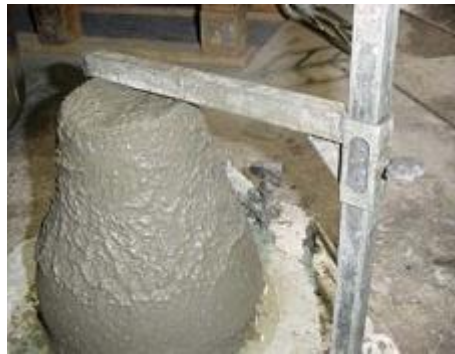
Figure 5.2 : Mesure de l'affaissement du béton frais au cône d'Abrams
