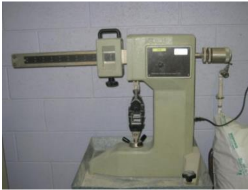
Figure 4-4 : Mesure de la résistance à la flexion des éprouvettes 4X4X16 cm
