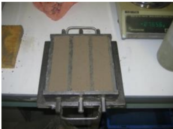
Figure 4-2 : Confection des éprouvettes prismatiques en mortier
