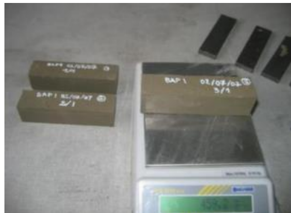
Figure 4-3 : Détermination de la masse volumique des éprouvettes par pesage
