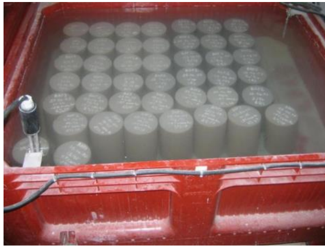
Figure 5.3 : Mode de Conservation des échantillons avant leur écrasement
