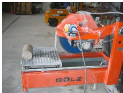
Figure 5.4 : Sciage des éprouvettes 16 x 32 cm de béton
