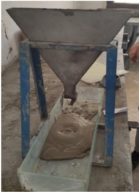
Figure III.19: Essai à l'Entonnoir en V
