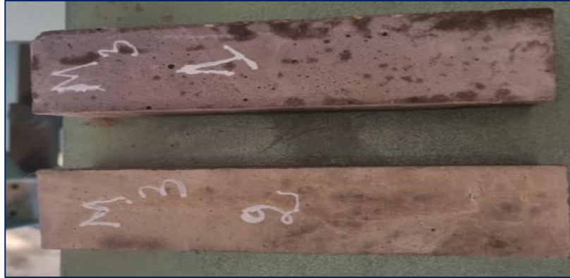
Figure III. 25. Dispositif expérimental pour l'essai d'absorption d'eau par capillarité
