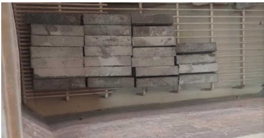
Figure III.16 : Conservation dans l'eau à 20°C
