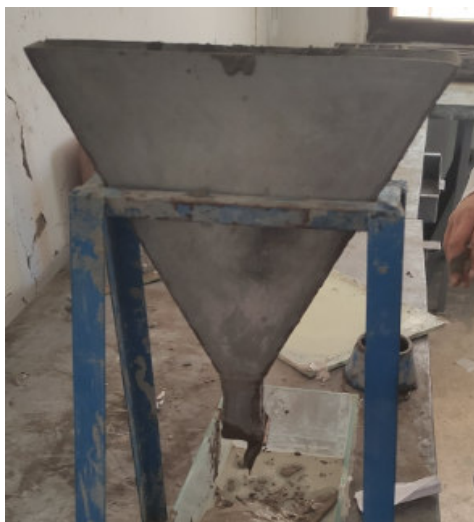
Figure I.9. Déroulement de l'essai d'entonnoir en V
