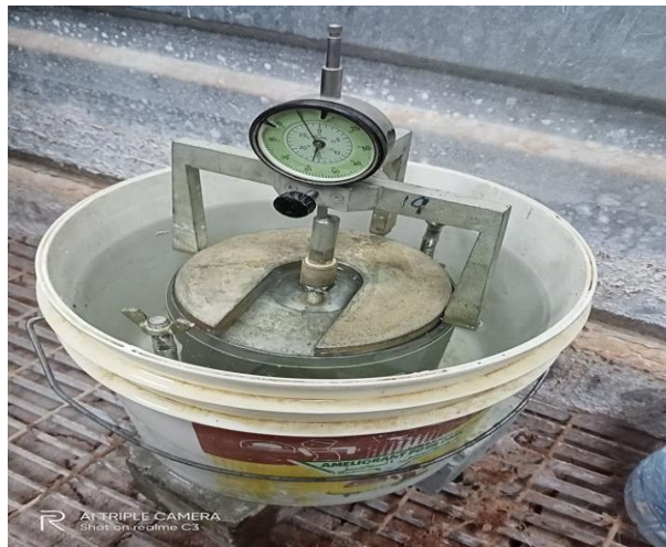
Figure 12 : Essai C.B.R après imbibition.
