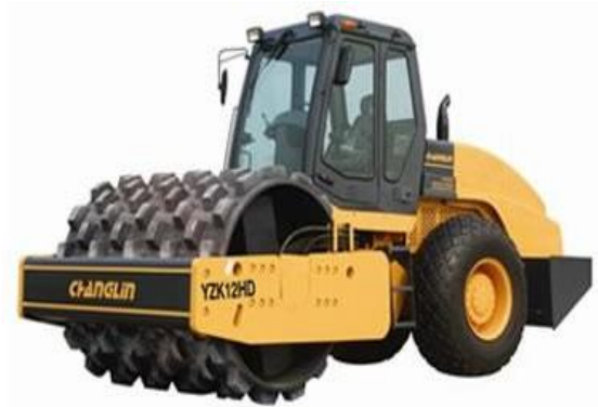
Figure 6 : Compacteur vibrant à pied dameur.
