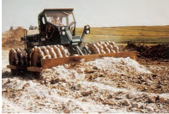
Figure 8 : Compacteur statique à pied dameur.
