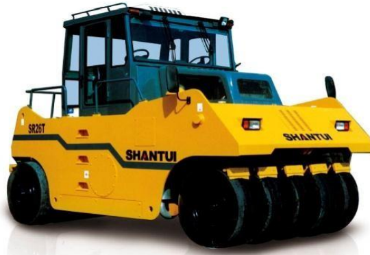
Figure 3 : Compacteur à pneu.
