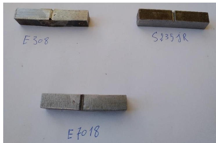
Figure IV.15 : Echantillons de résilience
