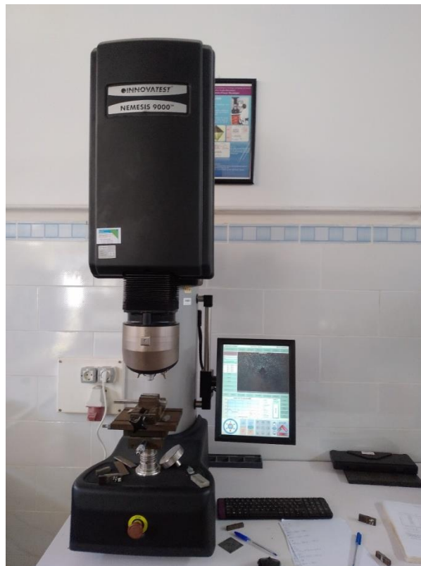
Figure IV.16. Appareils de mesure de dureté au niveau de CRTI
