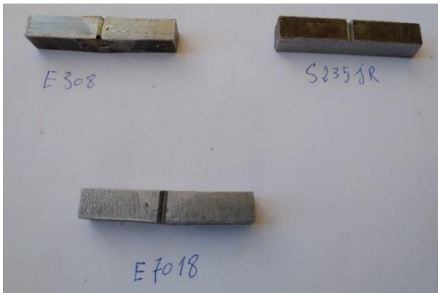
Figure IV.5. Eprouvettes de résilience
