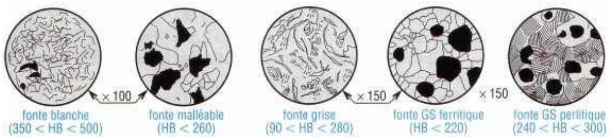
Figure I. 10. Microstructures des fontes usuelles.
