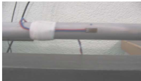
Figure IV.5: jauge CEA-13-062WT-350 collée sur la barre du dispositif BPHD
