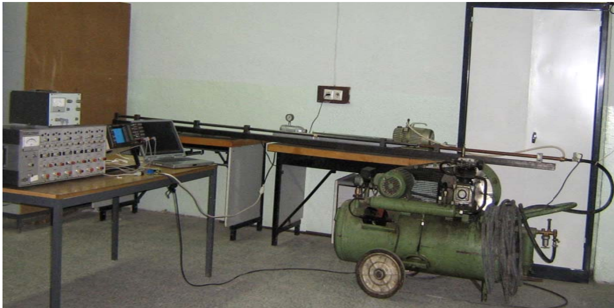
Figure IV.12: Photo du dispositif BPHD réalisé avec l'instrumentation associée
