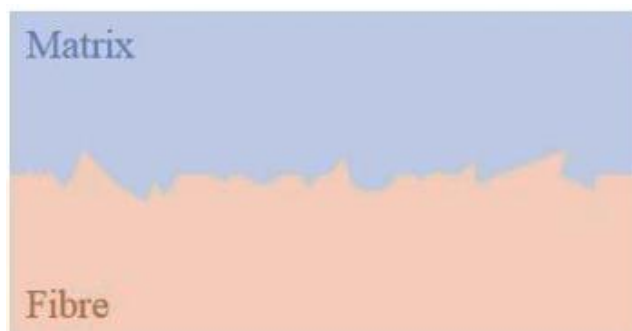
Figure I.14 Liaisons d'interface formées par emboîtement mécanique.
