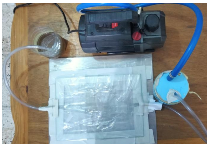
Figure II.15 Dispositif du moulage a sous vide.
