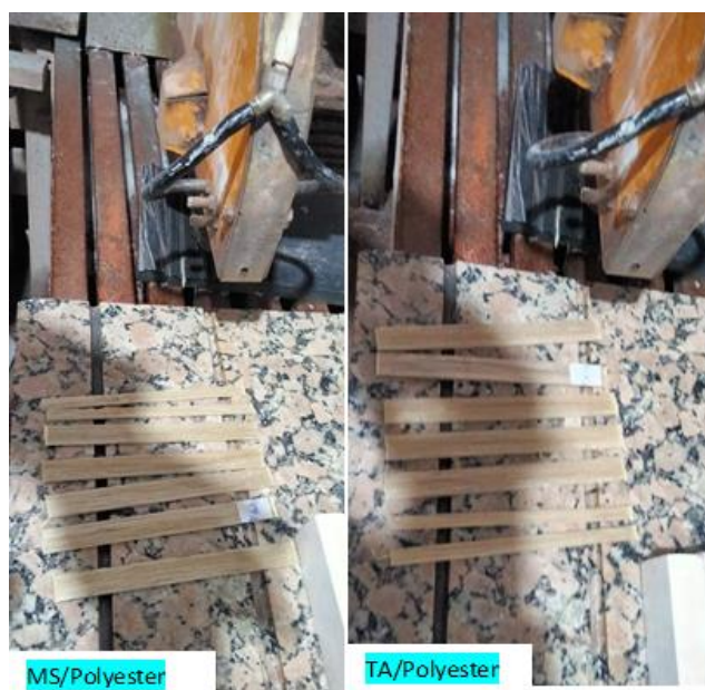
Figure II.17 Découpage des échantillons destinés à la caractérisation.
