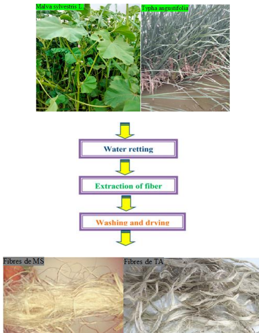
Figure II.4. Processus d'extraction des fibres MS et TA .
