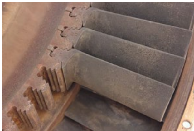
Figure 1.15: Ensemble des aubes rotor (au premier plan) et des aubes stator (second plan)
