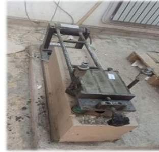
Figure III.19 : serrée mortier (Table de choc et des moules)
