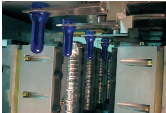
Figure (III.6) : les préformes en route vers les moules de soufflage.[9]
