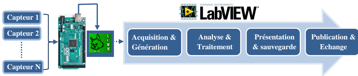
Figure 3.19: Interfaçage Arduino avec l'environnement LabVIEW
