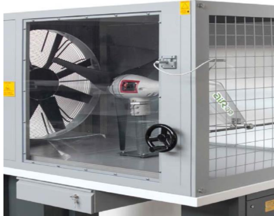
Figure 4.4 : Vue interne du tunnel du vent
