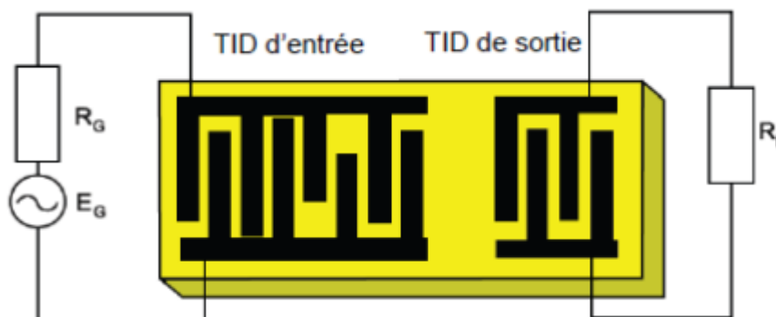
Figure I.5 : Schéma d'un dispositif à propagation d'onde acoustique de surface
