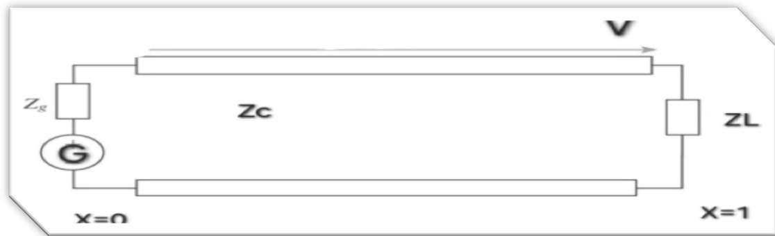
Figure 2. 1: Modèle de ligne de transmission (une longueur l et une impédance Z_c )
