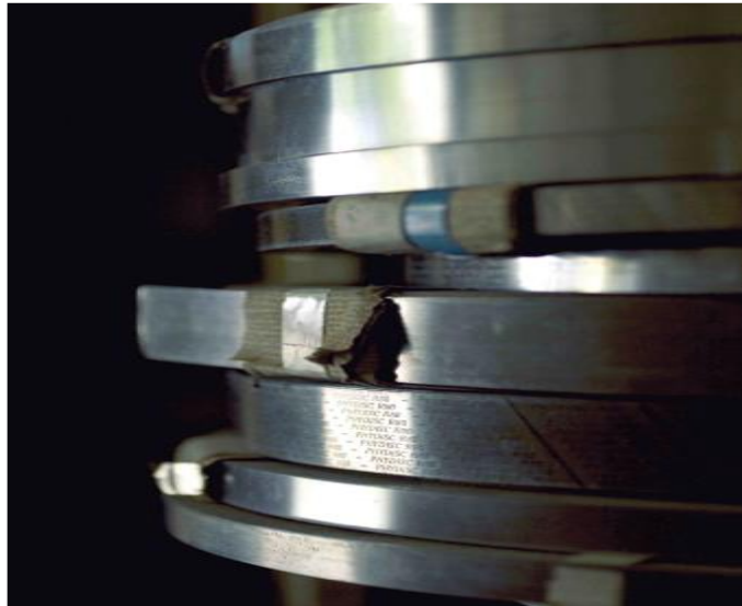
Figure II. 19: Rouleaux de bilames après laminage [11].
