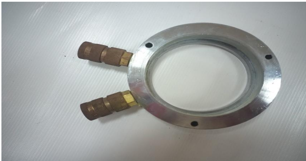
Figure.III.B.49 : Raccordement des flexible du fluide de refroidissement.
