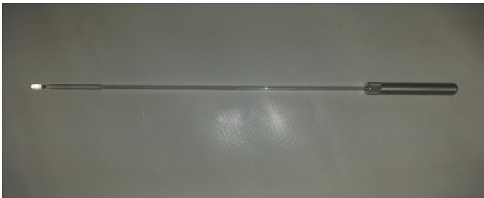
Figure.III.B.45 : La tige en verre cylindrique porte échantillon
