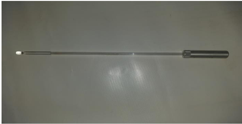
Figure.III. B.36 : Tige pour fixer l'échantillon.
