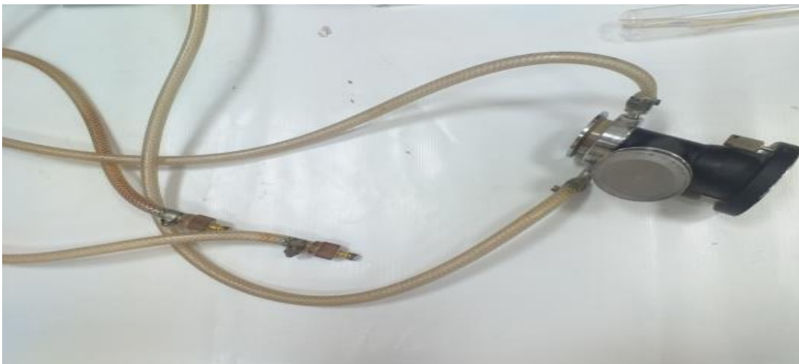
Figure.III.B.47 : Le coude et flexible pour l'alimentation de refroidissement du cylindre noir.
