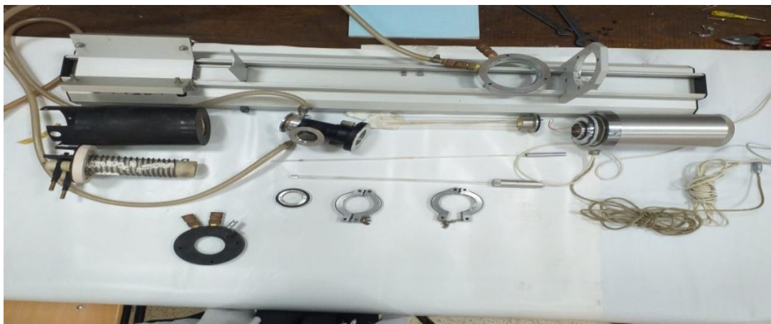
Figure.III.B.32 : Photo des composants du dilatomètre.
