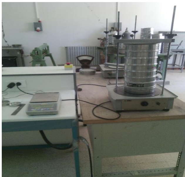
Figure II.2: Appareillage d'analyse granulométrique (tamisage).
