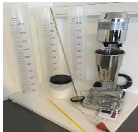
Figure II-3 - Essai Analyse granulométrique (par sédimentométrie).
