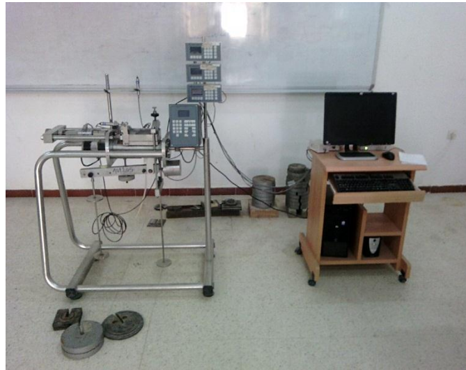
Figure II-11 - appareille de cisaillement direct.
