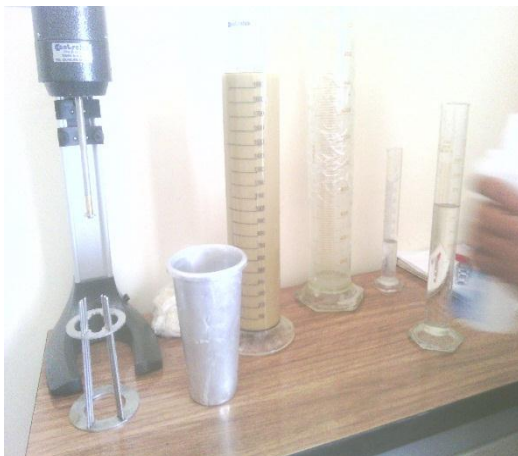
Figure II-3 - Essai Analyse granulométrique (par sédimentométrie).
