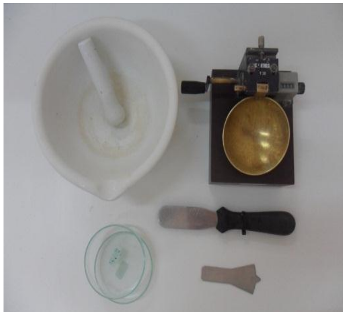
Figure II.4: Appareillage de limites d'Atterberg.
