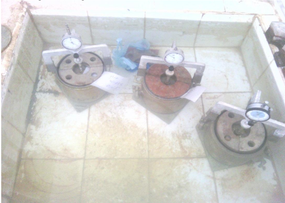
Figure II-10 - Imbibition des essais de C.B.R.
