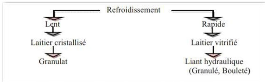
Figure 2.2: Processus d'élaboration des différents types de laitiers [19]
