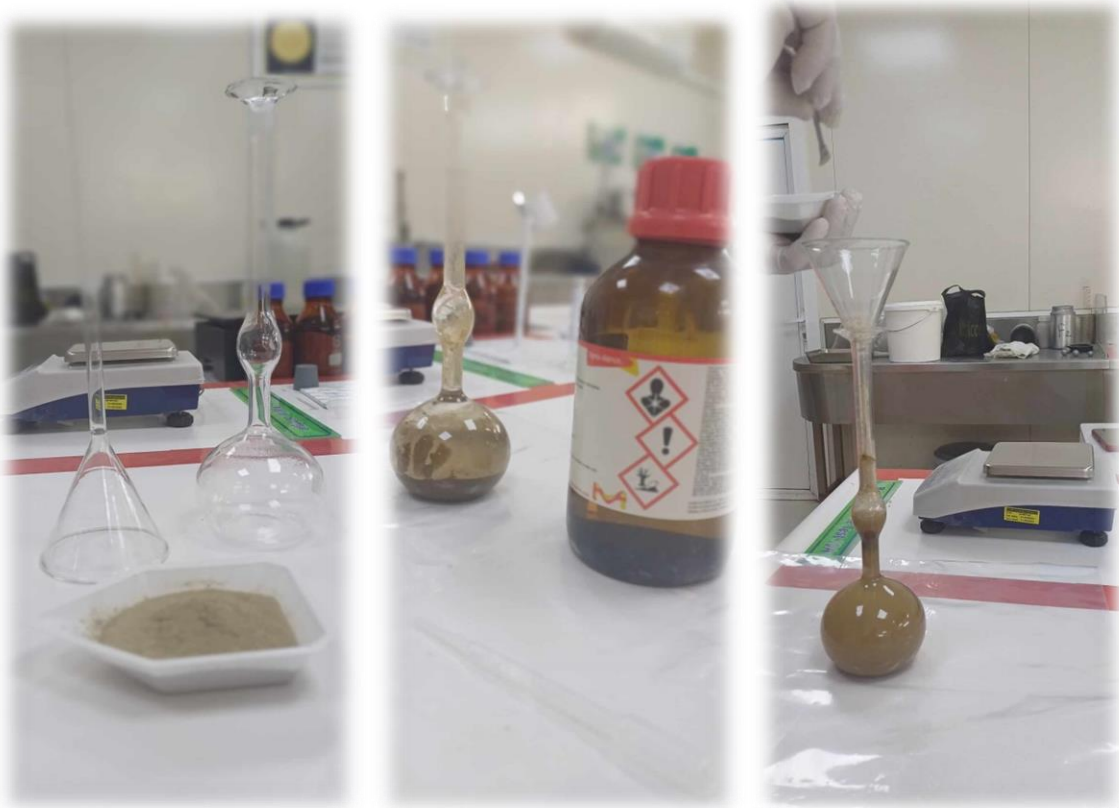
Figure 3.11: essais de masse volumique absolue du echantillon de laitier granulé, (laboratoire de Lafarge, (Hammam Dallaa – M'silla).
