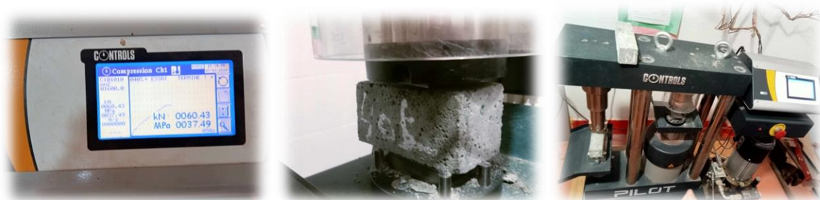
Figure 3.17 :Appareil de compression et de traction (Laboratoire Géo matériaux Université -M'SILA).
