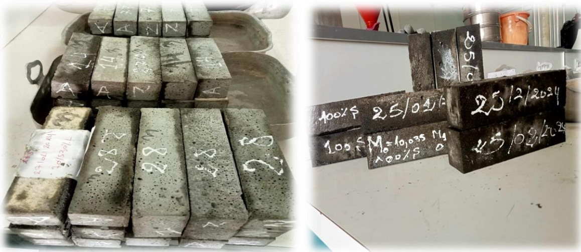
Figure 3.15: les éprouvettes des mortiers a l'état humide (Laboratoire Géo matériaux , Universités de M'SILA).
