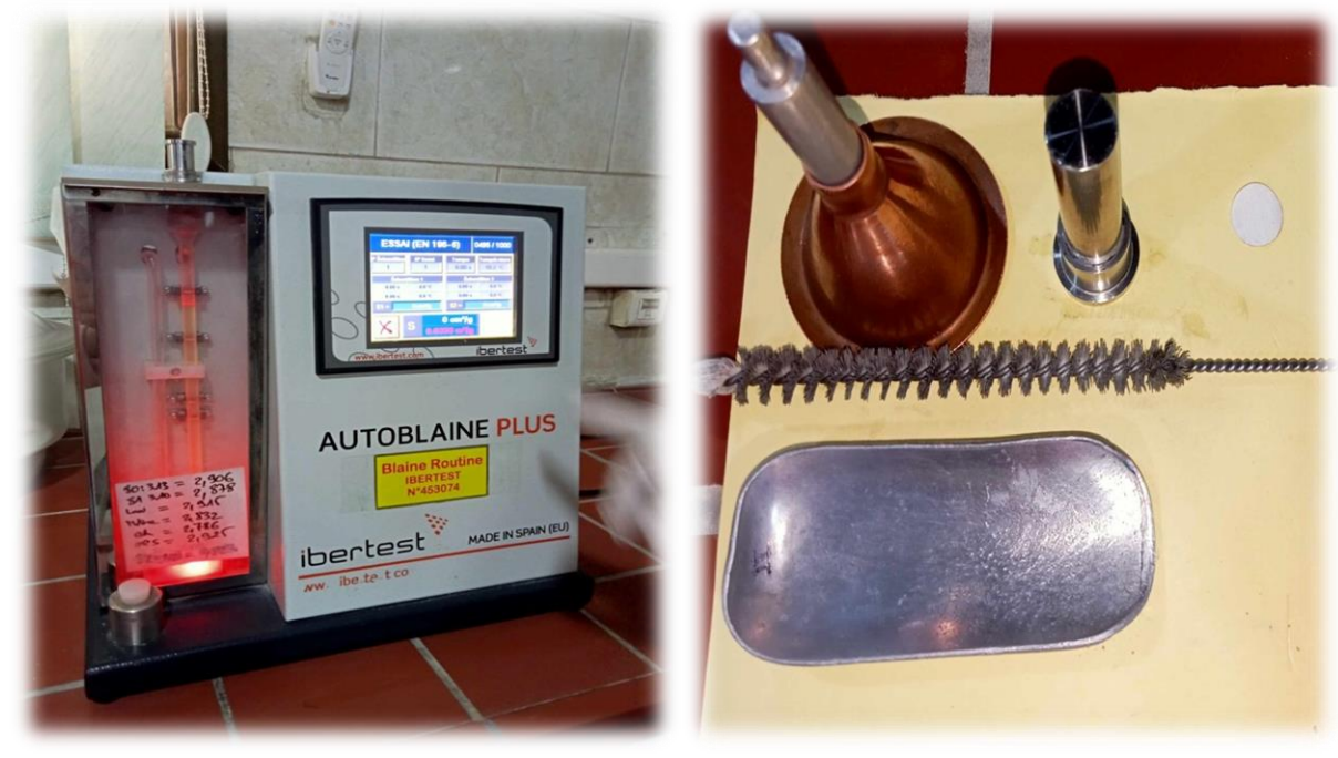
Figure 3.13 :essai surface spécifique sur laitier granulé, (laboratoire de Lafarge, Hammam Dallah – M'sila).
