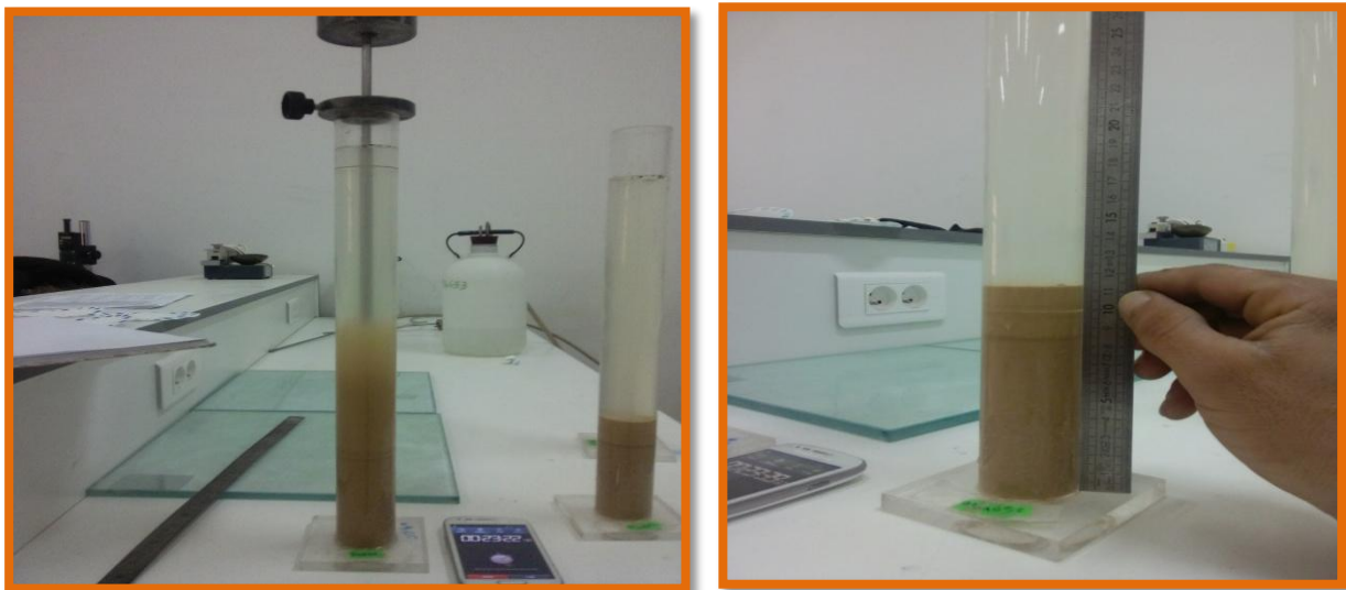
Figure .II.10 : Lire la hauteur H_1 et H_2 par la règle.
