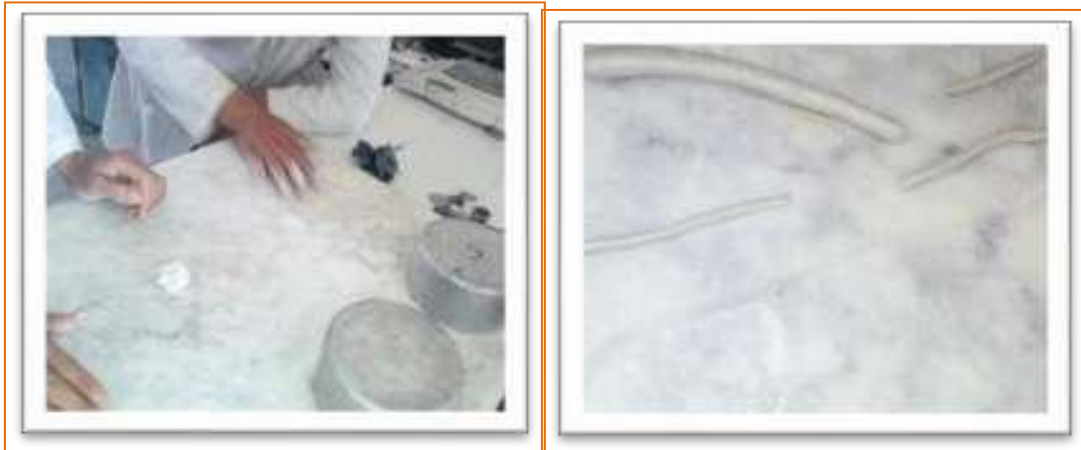
Figure .II.14 : les étapes de la limite de plasticité.
