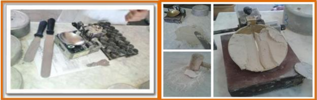
Figure .II.13 : Appareil de Casagrande et matériel de la limite de liquidité pour kaolin.
