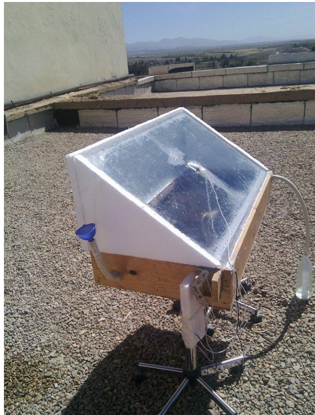
Fig. III.2- distillateur solaire simple
