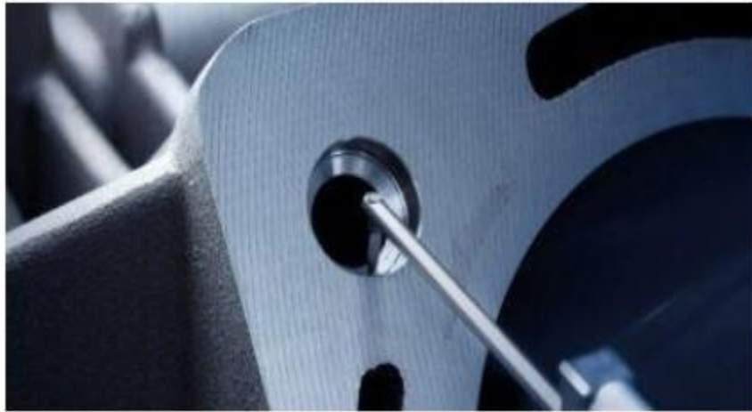
Figure.III.8 : Rugosimètre avec patin
