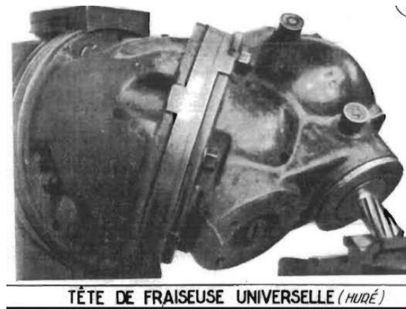
Figure. II.11 : Fraiseuse Universelle (Huré)
