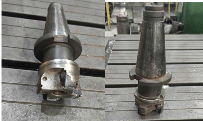
Figure. IV.2 : Fraise à surface à plaquettes C.M
