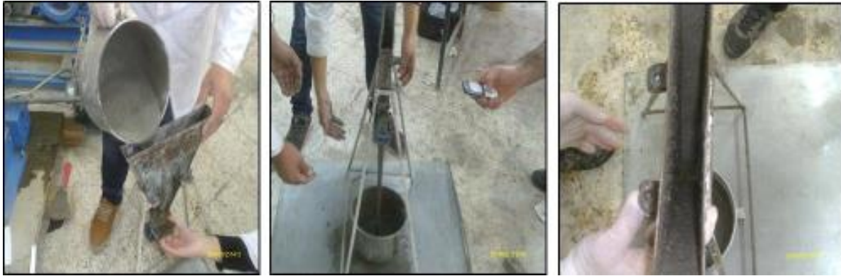
Figure I.6 : Essai d'écoulement au mini-entonnoir en V sur MAP [25].
