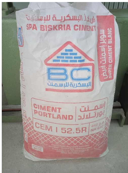
Figure II.8 : Sac de ciment blanc qui est disponible au niveau de SPA Biskria ciment.
