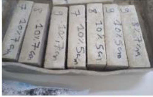
Eprouvettes mortiers autoplaçant avant l'écrasement
