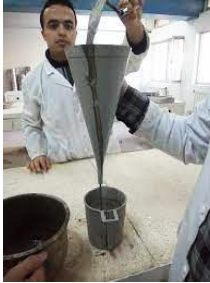
Figure I.5 : Essai au cône de Marsh [24].
