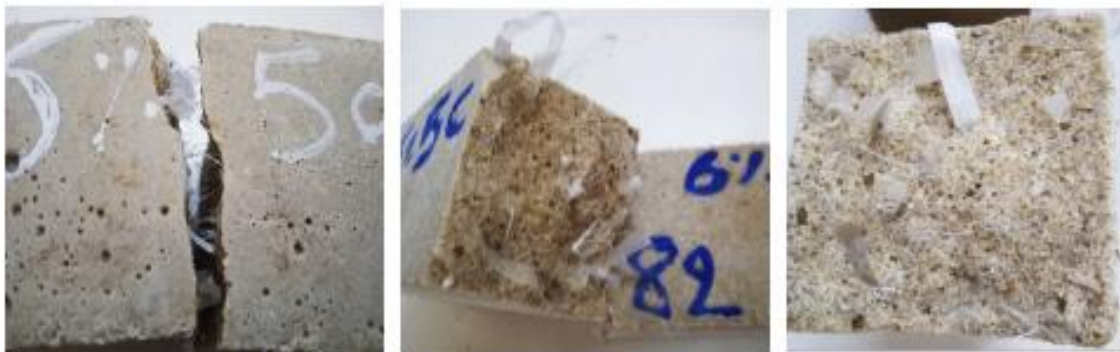
Eprouvettes de mortier autoplaçant après l'écrasement
