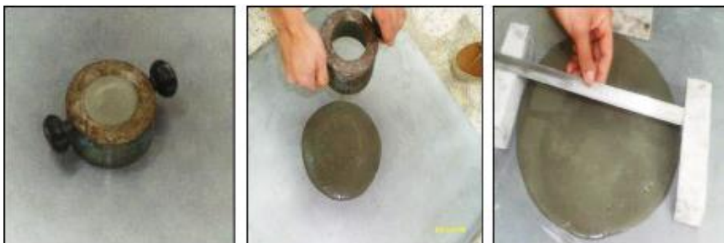
Figure I.4 : Essai de Mini cône sur le mortier autoplaçant [23].
