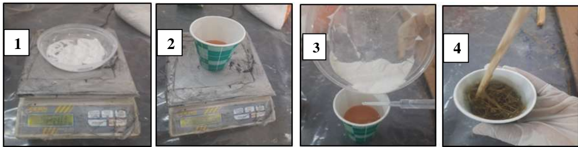
Figure III.9 : Préparation de matériaux composite
