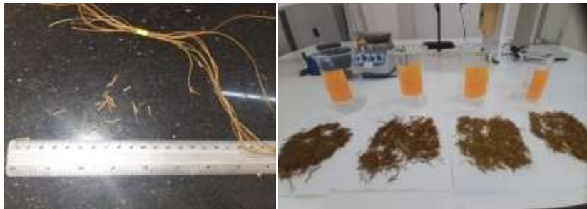
Figure III.6 : Découpage les fibres d'Alfa en longueur de 1cm
