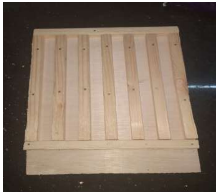
FigureIII.7 : Moule en bois utilisé durant l'élaboration.
