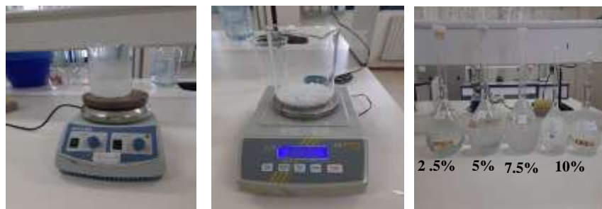
Figure III.13.1: préparation du solution de NaOH de (2 ,5% ; 5% ; 7,5% ; 10%)
