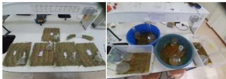
Figure III.13.2: Les fibres d'Alfa été immergée dans une solution de NaOH
